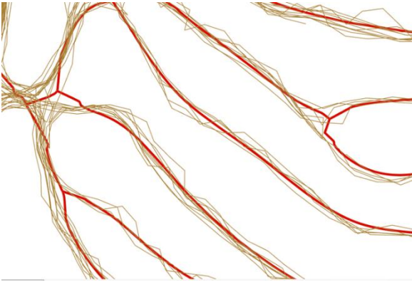
Kuva 17. Hakkuukoneen ja kuormatraktorin reitinjäljitys kullakin ajokerralla on visualisoitu ruskealla viivalla. Punainen viiva kuvaa uudella menetelmällä laskettua ajouran keskilinjaa.
